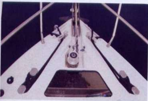
In alto, la chiusura del tuna door, che diventa un timentibene verticale. Sopra, la tasca realizzata sulla murata per contenere la coda delle cime e mantenere il pozzetto sgombro. Sotto, il posto di manovra di prora. Il pozzo catene è diviso in due zone separate.
