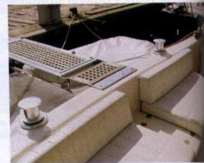
In alto, il prendisole sul flybridge. Sopra e sotto, la disposizione inusuale di bitte e verricelli di tonneggio sul coronamento dello specchio di poppa.
