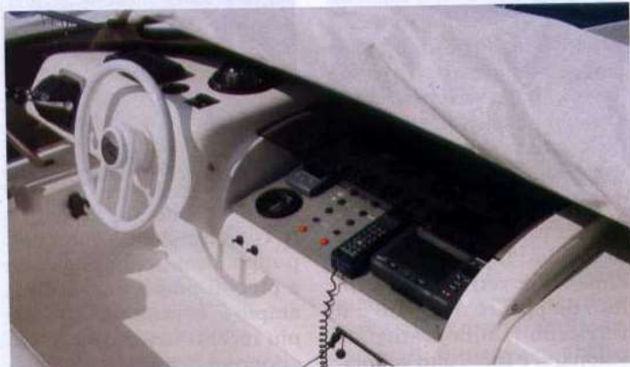
La timoneria sul flybridge. La strumentazione è protetta da una palpebra in plexiglass per il buon mantenimento dell'attrezzatura.
