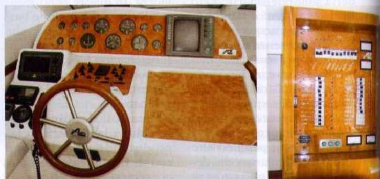
Sopra, la timoneria interna e il quadro elettrico principale. Quest'ultimo è a sinistra del posto di guida in basso, posizione raggiungibile con difficoltà durante la guida.
